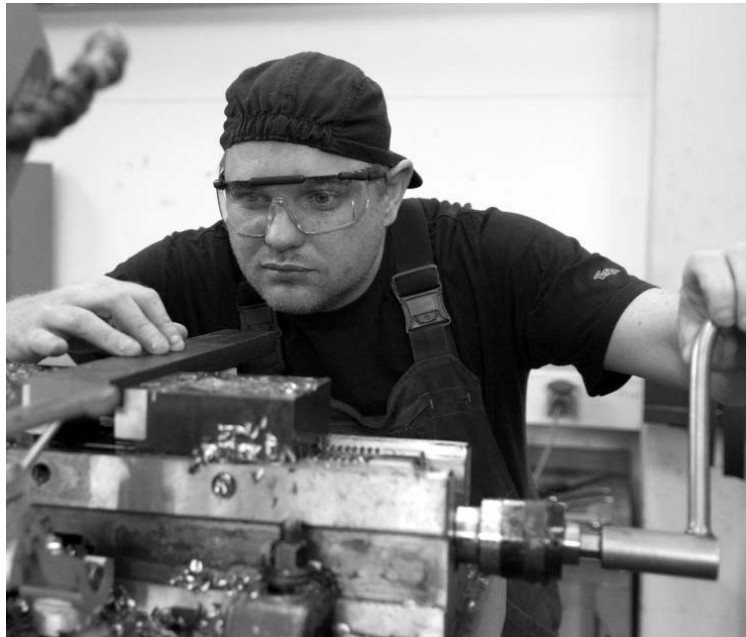
Martin Gerken spannt ein Flacheisen zum Fräsen in den Schraubstock.
