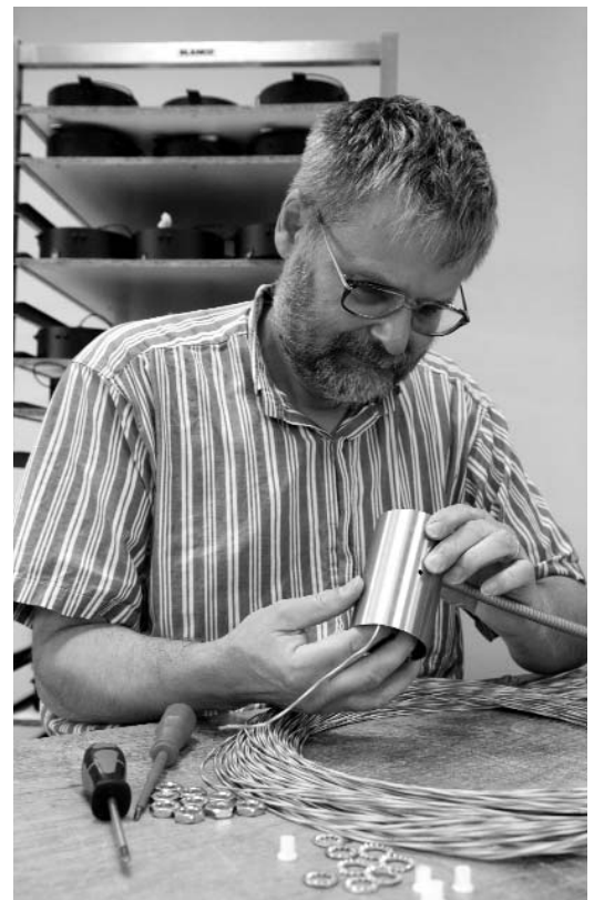
Elektromontage von Lampenfassungen in Elbe 2
