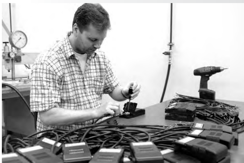
Montage von Lampentrafos im Betrieb Elbe 2
